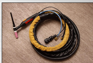
TR 18 hegesztőpisztoly Módosított víz-, gáz- és vezérlő csatlakozókkal, hollandis kábelcsatlakozással
